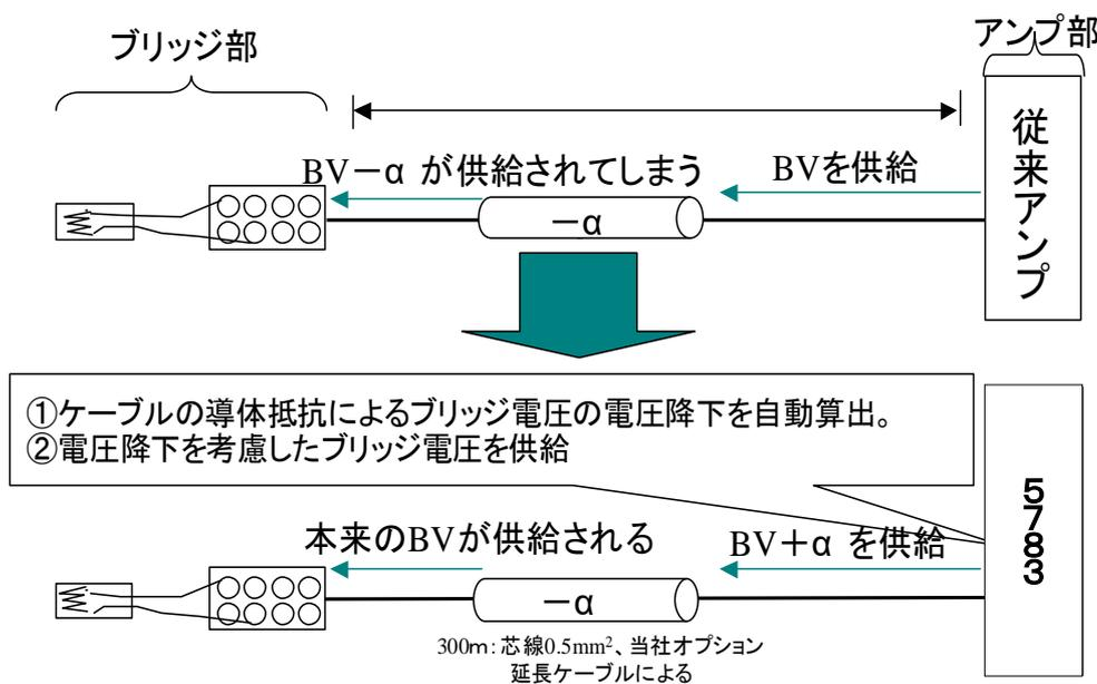
図 3-4 線長補正機能の概略図
