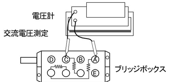
図 4-8 ブリッジ部の電圧測定
